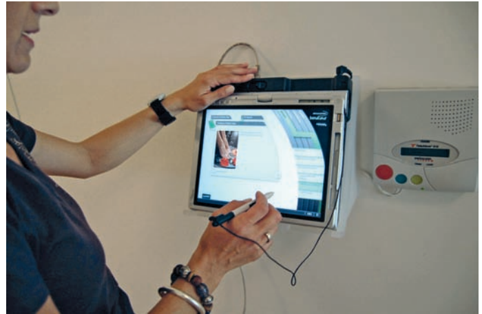
Notruf: Neben dem an der Wand platzierten Tablet-PC befindet sich auch der Notruf, über den medizinische oder pflegerische Hilfe angefordert werden kann. Drahtlos damit verbunden ist ein Armband, über das der Notruf ebenfalls ausgelöst werden kann.
