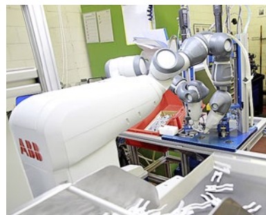
YuMi bei der Arbeit: In der Hawa Sliding Solutions AG baut der smarte Roboter Türelemente zusammen.
